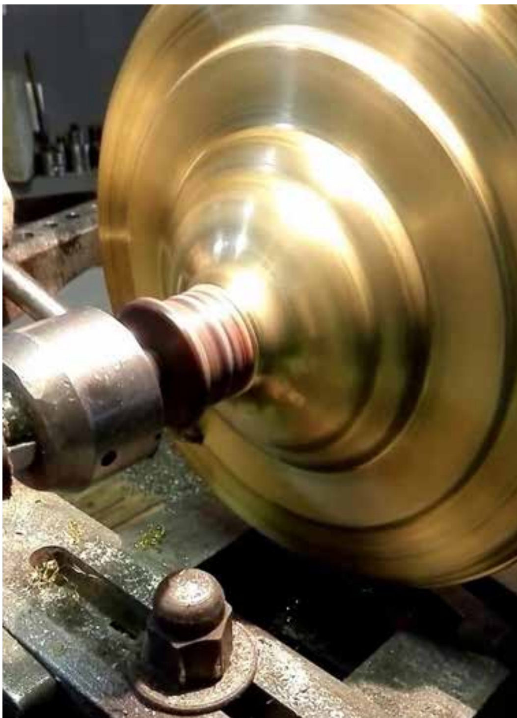
Ил. 16. Ротационная вытяжка латунной детали подсвечника. Фото: https://www.youtube.com/watch?v=6FQu9dq-MNc
