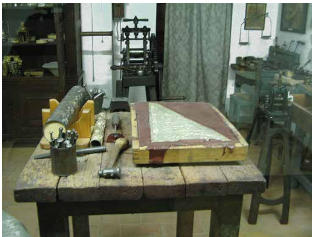
Ил. 13. Инструменты и приспособления для листовой чеканки. Фото автора, 2014 г. Музей ремесел, Севилья (Испания)
