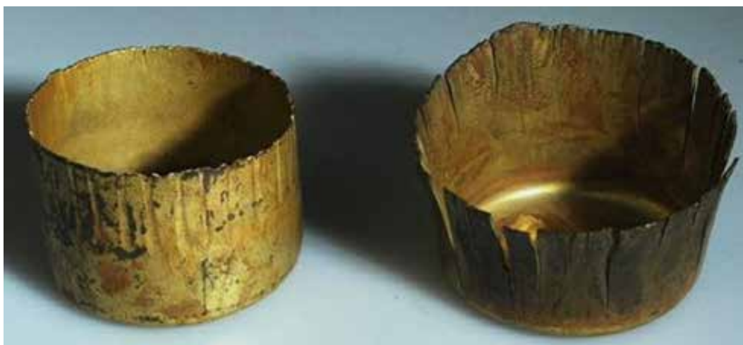
Ил. 15. Растрескивание латунных капсюлей в результате «аммиачной атаки». Фото: https://en.wikipedia.org/wiki/Brass#/media/File:BrassSCC1.jpg
