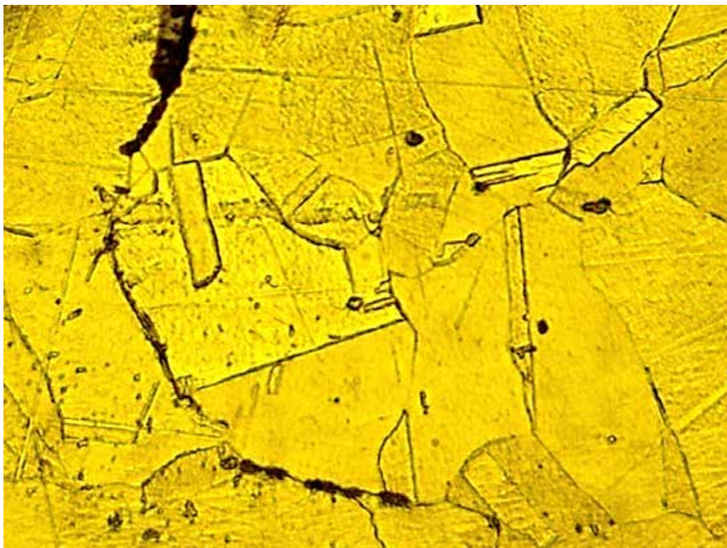
Илл. 4. Микроструктура изделия b_1 с выделением слоя окиси меди и ее глобулей вдоль границ зерен (участок 2). Увеличение: \times 850
