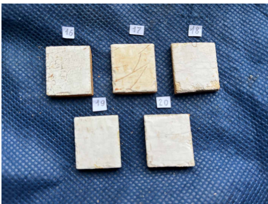
Ил. 4. Образцы клее-мелового грунта XIX в. после обработки парами растворителей, компонентами эфирных масел и 30-часового старения: 16 — спирт; 17 — эвгенол; 18 — терпинеол; 19 — пинен; 20 — цитраль
