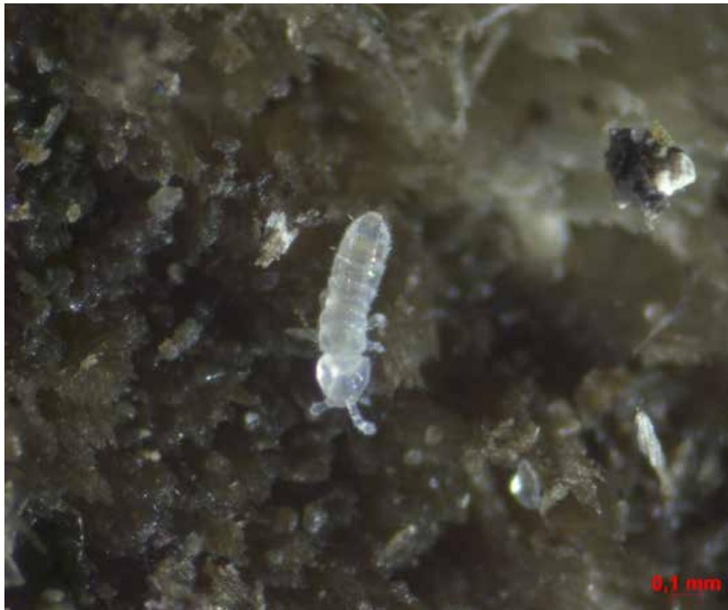
**Ил. 4.** Образец древесины конструкции ледника: видны частички грунтовых загрязнений и мелкие бесцветные насекомые отряда Коллембола, или Ногохвостки (*Collembola*), семейство *Onychiuridae*. Волокна древесины набухшие, местами деформированы, поломаны. Фотография сделана с помощью стереомикроскопа Zeiss Stemi 2000-C.
