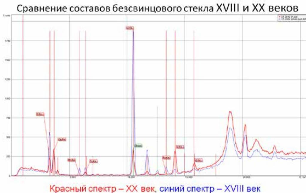
**Ил. 5.** Пример сравнения составов бесцветного бесцветного стекла, произведенного в XVIII и в середине XX века. Наложение двух спектров, полученных на портативном рентгенофлуоресцентном спектрометре
