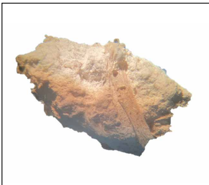
Ил. 7. Фрагмент кладочного раствора. Успенский кафедральный собор, г. Владимир. Фото Е. А. Репина, 2024 г.
