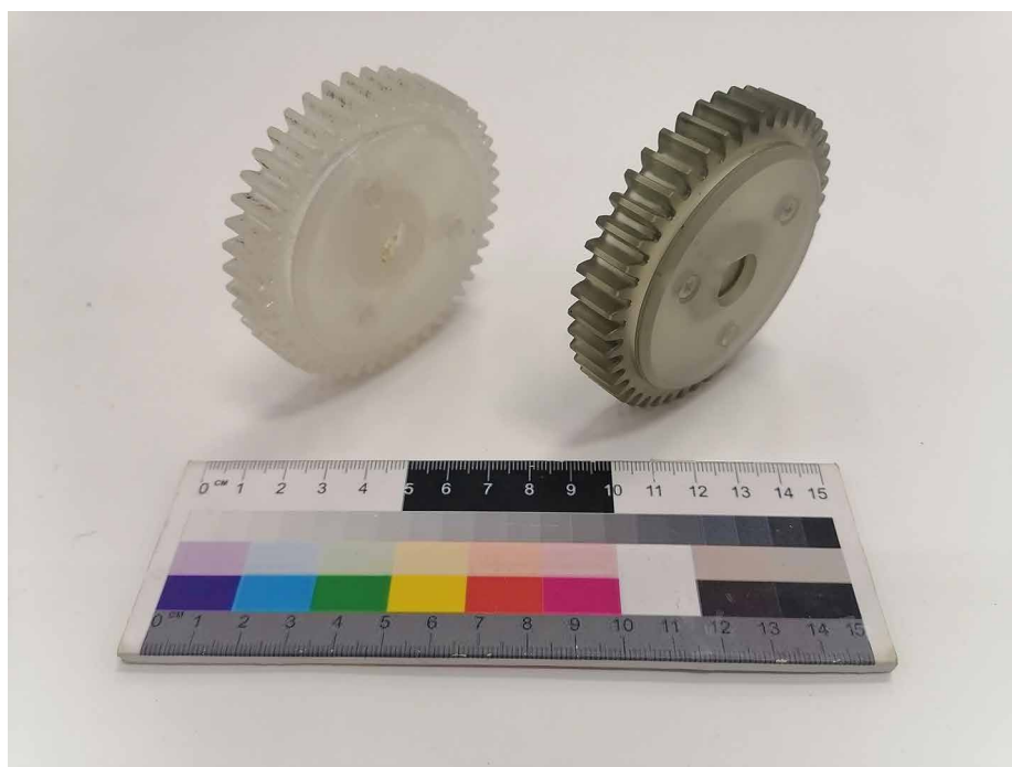
Ил. 5. Прозрачные шестерни, выполненные FDM- (слева) и LCD- (справа) способами аддитивной 3D-печати из PETG и eResin-PLA пластиков соответственно. Фото авторов
