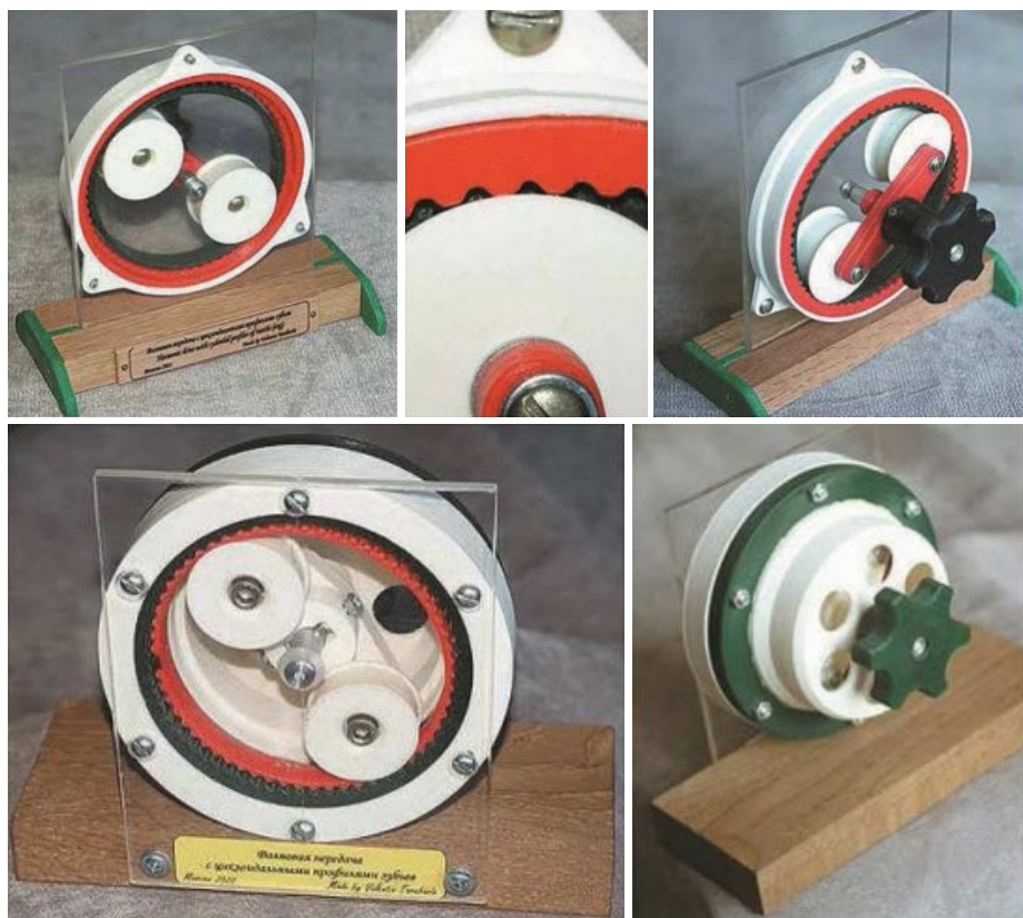
Ил. 5. Модели редуктора с волновой зубчатой передачей и циклоидальными профилями зубьев, выполненной методами аддитивной печати. Фото авторов
