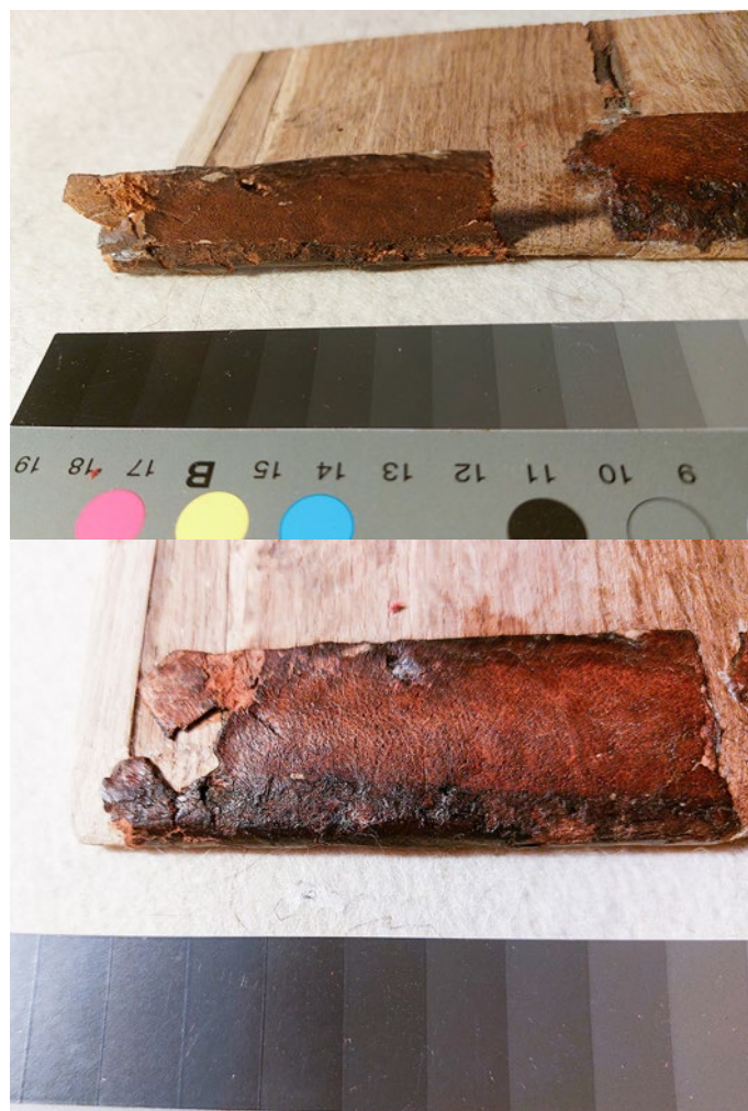
Ил. 5. Образец кожи № 6 после обработки. Приклеен к переплетной доске с помощью кроличьего клея
