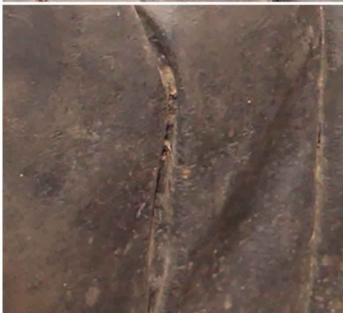
Ил. 7. Фрагменты кожи с трещинами на спинках салона. Октябрь 2023 г.
