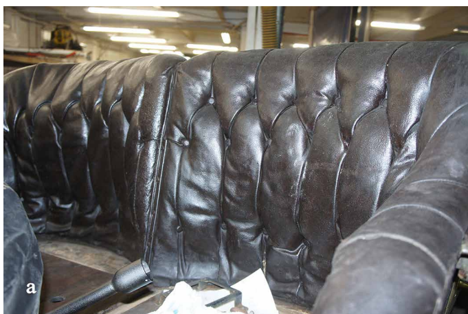
Ил. 7. Фрагменты кожи с трещинами на спинках салона. Октябрь 2023 г.
